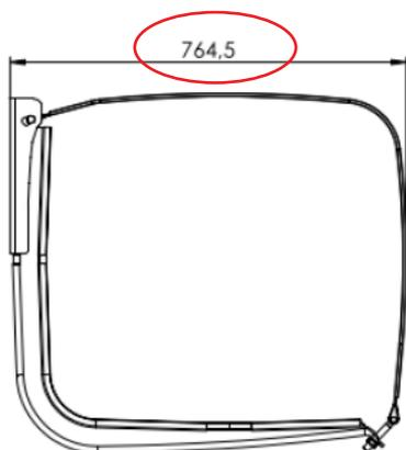
La nuova forma del supporto ci ha permesso di ridurre di 17,5 mm. l'ingombro in profondità dell'assieme supporto + serbatoio facendone una soluzione estremamente flessibile ed in grado di essere installata in modo facile e veloce anche sui veicoli dotati di carenature laterali.
